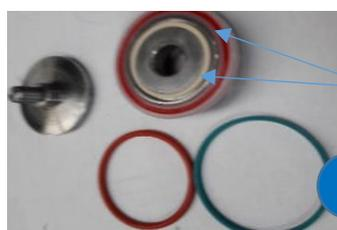
Déposer le joint racler, ainsi que le joint torique
