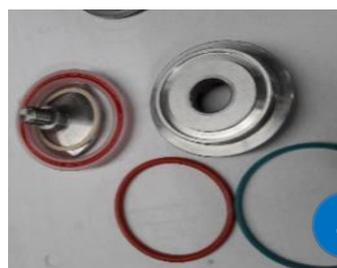
Le démontage est fini, il ne reste plus qu'à remplacer le kit de joint 41JON001A ou B et suivre le même process en sens inverse.
