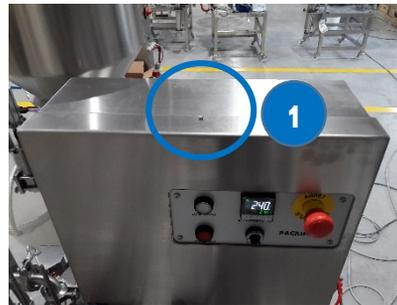
**1** Démontez le capot avant de la machine via les 5 vis de fixation repérées sur les photos ci-contre à l'aide d'une clé de 7 ou d'une clé doseur.
